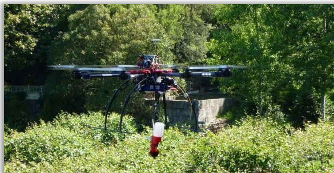
Imagen 11: Trabajos fitosanitarios empleando maquinaria que provoca menor impacto en el medio y nuevas tecnologías para aplicación localizada por medio de vehículos aéreos no tripulados para actuaciones localizadas.
