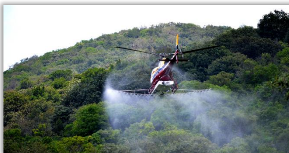
Imagen 10: Trabajos fitosanitarios empleando maquinaria de dispersión para grandes superficies. Medios terrestres y aéreos que tienen un amplio rango pero que pueden afectar en mayor medida al medio.
