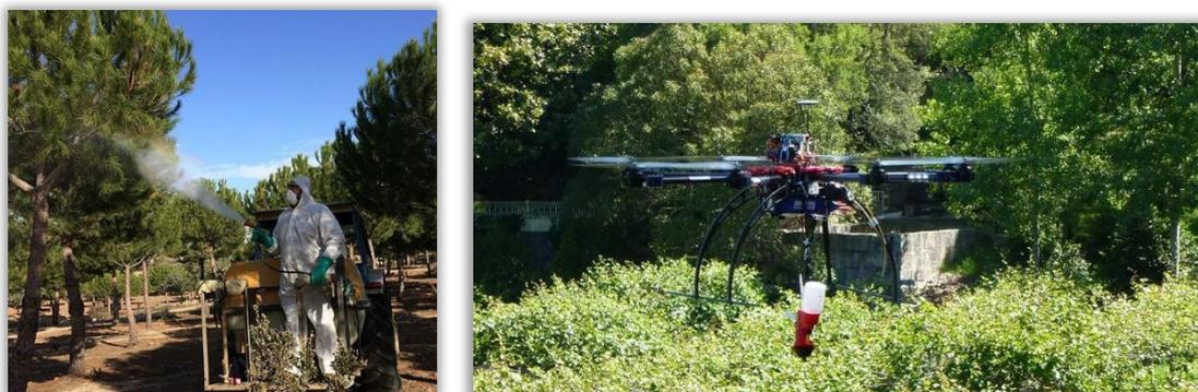
**Imagen 11:** Trabajos fitosanitarios empleando maquinaria que provoca menor impacto en el medio y nuevas tecnologías para aplicación localizada por medio de vehículos aéreos no tripulados para actuaciones localizadas.
