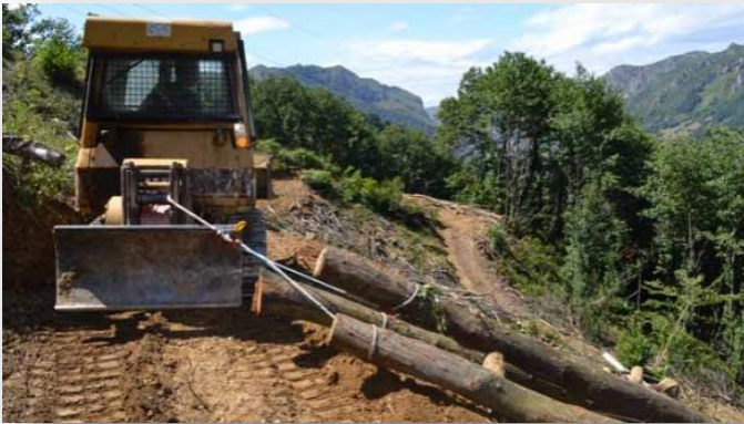
Figura 5 – Exploração florestal com extração dos toros por arrastamento
